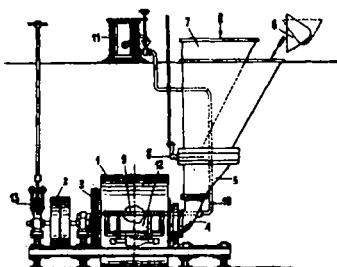
in großer und Wasser zur Anfeuchtung des Mehles in kleiner Menge zuführt und die Trommel so lange rotieren lässt, bis sich die Koksstückchen durch Überziehen mit Rohmehlschichten zu ballenförmigen Körpern ausgewachsen haben. —
