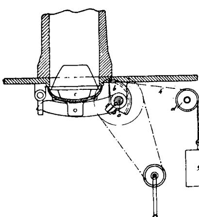
Das daumenartige Segment ist so gebaut, daß seine Hebelwirkung bei der geschlossenen, horizontalen Lage des Verschlußdeckels *c* am größten ist, beim Öffnen des Deckels *c* allmählich abnimmt und schließlich bei voll geöffnetem Deckel gleich Null wird. Der Deckel bleibt mittin von selbst in seiner geöffneten Lage stehen. (D. R. P. Kl. 26a. Vom 6. 4. 1916 ab. Ausgeg. 2./2. 1917.) rf. [R. 352.]
